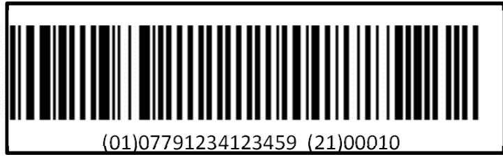
الشكل ١: مثال على الترميز الخطي بالباركود
