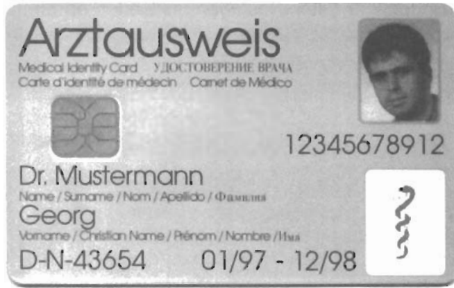
Figura 5. Una de las primeras tarjetas de identidad con circuito integrado para profesionales de la salud (1996).
