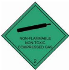
图 5、液氮的危害标签；用液氮（见“制冷剂”部分）包装的物质除了要使用基本的危害标签（如图 3 中的 A 类感染性物质标签，图 10 中的 B 类感染性物质唛头）以外，还必须张贴这一标签。
