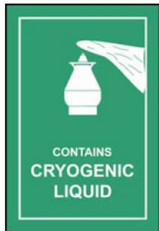
图 6、低温液体的危害标签；空运时如果使用低温液体（低温冷藏的液化气体，见“制冷剂”部分），则在用作外层包装的隔热容器或保温瓶上除了张贴必要的图 3、图 5 以及图 10 所示的标签或唛头标志以外，还必须张贴这一标签。
