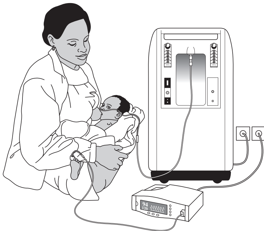
Figure 2. Installation habituelle d'un concentrateur d'oxygène avec oxymètre et tubulure d'alimentation du patient en oxygène
