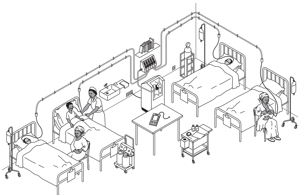
Figure 8. Exemple d'installation d'un concentrateur d'oxygène dans un service de pédiatrie
