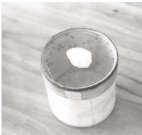
Fig. 13 La jaula de mantenimiento. Después de la exposición en la jaula de bioensayo, se transfieren los mosquitos a una jaula de mantenimiento simple a temperatura ambiente. La mortalidad es determinada después de 24 horas.
