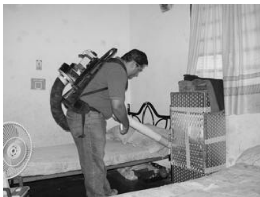
Fig. 11. El aspirador tipo mochila. El dispositivo es fácil de construir usando como soporte una mochila, junto con un motor de aire acondicionado y un ventilador de automóvil, un mango flexible, y un tubo de PVC.
