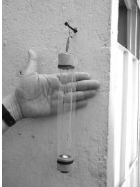
Fig. 12. Bioensayo de jaula. El tubo se fabrica con una malla de nilón 16. Los extremos se tapan con una clavija de 2.5 cm con 2cm de largo aseguradas por un tarugo de caucho. Los mosquitos se introducen a través de un agujero en la parte de abajo a través de un tapón que es cerrado con un taco de lana de algodón empapado en el agua.
