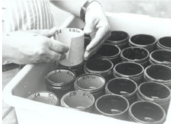
Fig. 7. Inserción del papel en la ovitrampa. Los papeles se pre-etiquetan con un lápiz escribiendo el número de sitio y fecha. El papel rugoso absorbente se corta a un tamaño tal que encaje y se superponga de forma que la superficie interior del frasco no sea expuesta.
