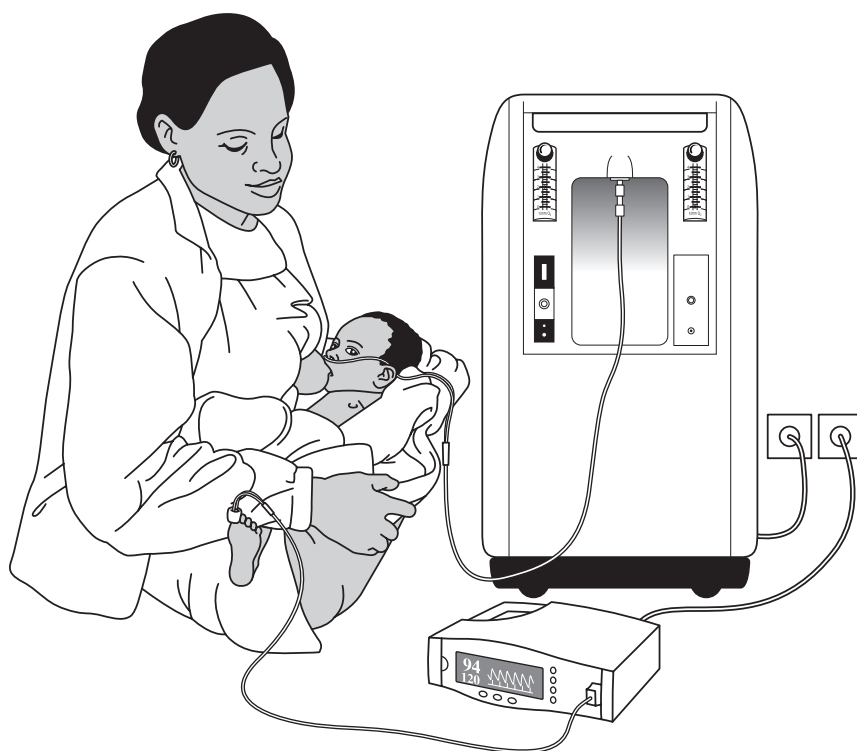
Figura 2. Disposición del concentrador de oxígeno, el oxímetro de pulso y la conexión al paciente
