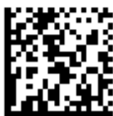
Рисунок 2: пример двухмерного матричного штрих-кода
