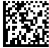
الشكل ٢: مثال على الترميز ذو البعدين بالأعمدة المتوازية الحاوي على مصفوفة البيانات
